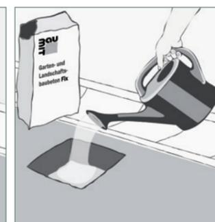
3 Das Material gut durchnässen. Nach ca. 3 Minuten wird die nächste Lage Material (10 cm) eingebracht.
